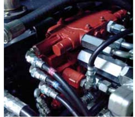
3 Pumpen ermöglichen unabhängige Bewegungen des Auslegers, Löffelstiels und Schwenkwerks.
