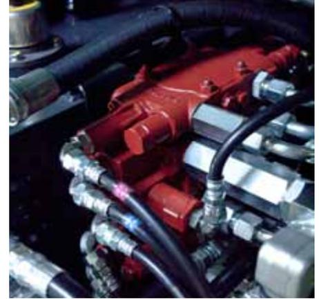
3 Pumpen ermöglichen unabhängige Bewegungen des Auslegers, Löffelstiel und Schwenkwerks.
