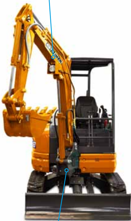
Die asymmetrische Anordnung des Auslegers in Bezug auf den Drehkranz gewährt dem Fahrer ausgezeichnete Sicht auf den Aushub
