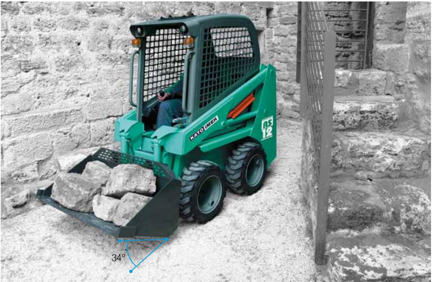
Der vergrößerte Einkippwinkel der Schaufel verhindert Materialverluste während des Transports.
