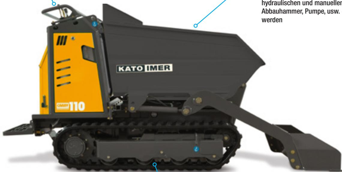
Die mittig angeordneten Kipprollen bieten eine größere Auflagefläche und höheren Komfort als feststehende Rollen.
